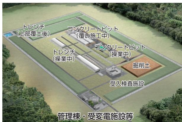
原子力機構が実施した埋設施設の概念設計より
